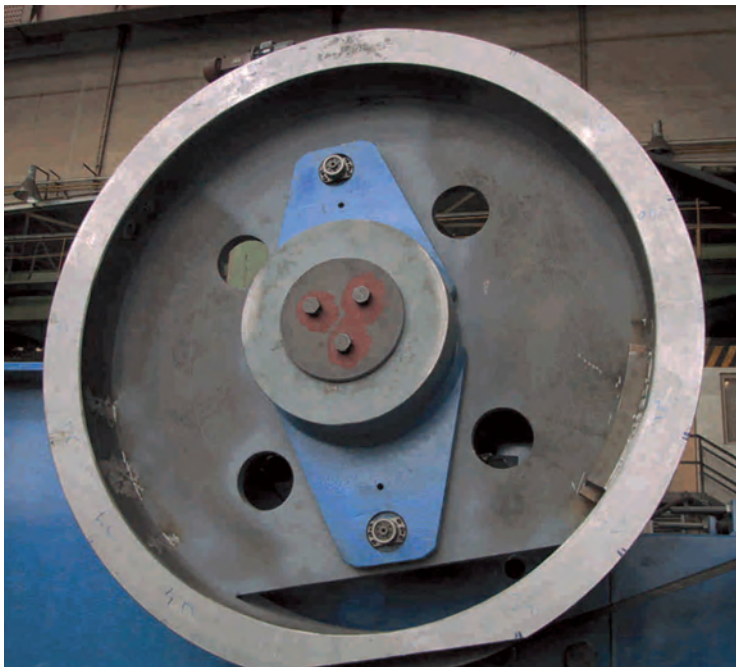
Dettaglio sistema di protezione con frizione sui volani
